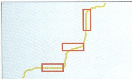
Abb. 12: Sicherungsbrücken längs zu den Rissen, stark vergrößert dargestellt
