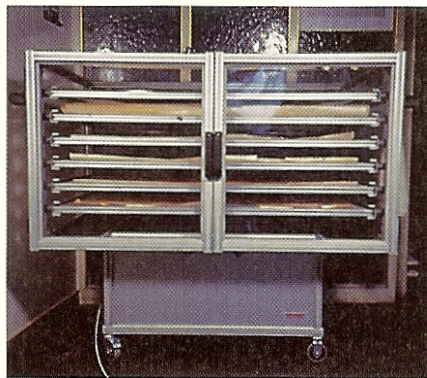
Abb. 6: Befeuchtungskammer mit 6 Beschickungsebenen
