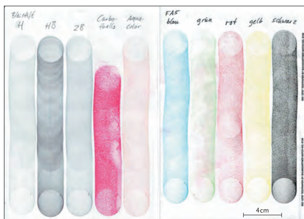
Abb. 9: Testblatt, entwickelt mit der Firma Stabilo International, Heroldsberg. Farbaufträge von links nach rechts: Bleistifte der Stärken H, HB und B der Marke Stabilo, Pastellstift Carbothello rot der Marke Stabilo, Farbstifte FA5 blau, grün, rot, gelb und schwarz der Marke Stabilo
